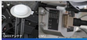
GNSS/IMU (位置姿勢計測装置)
