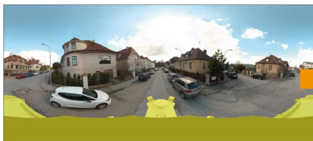
左：最大134 MP 1) のLadybug 6パノラマ画像と隙間を埋めるためのユーザー定義のマスク
