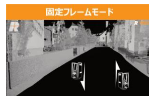
固定フレームモード 等間隔配置の追加モード (左右を取得する際は2回のパスが必要)
