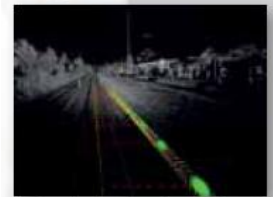
プラットフォームのコーナーへの最短距離検知 の為の解析による中心線の自動抽出。
