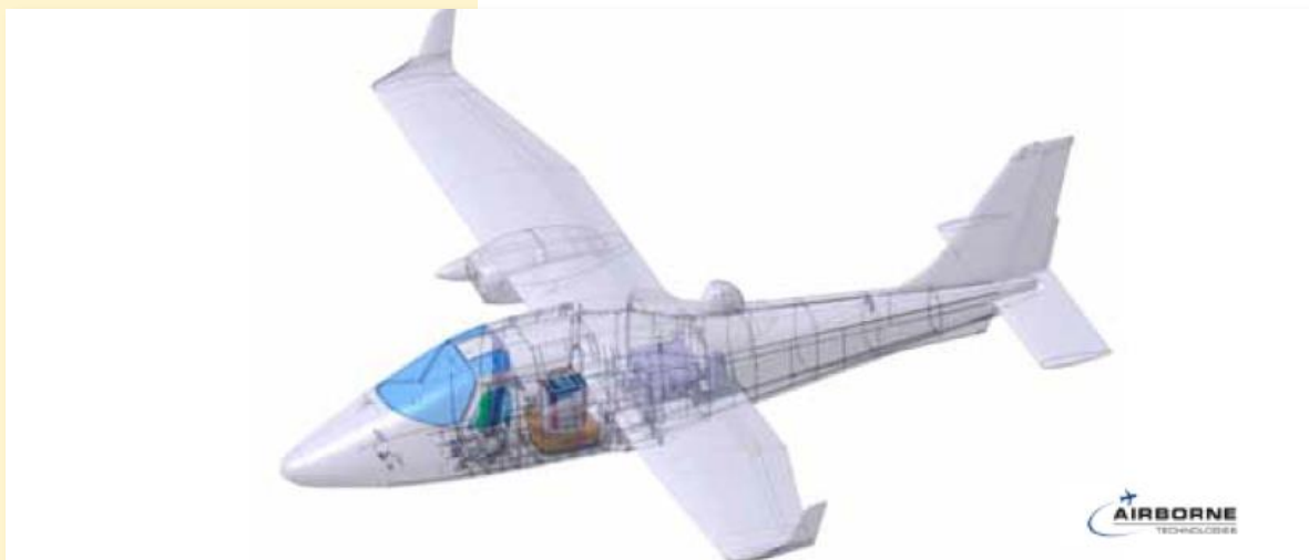
RIEGL LMS-Q1560 を固定翼 TECNAM MMA の GSM-3000 に取り付け
