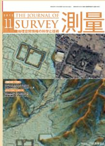
表紙左上の平面図は航空レーザ計測システムのデータから樹木などのノイズを処理した地盤のランダム点群を格子で内挿して数値地形モデル(DTM)にし、陰陽図にしたものです。右上は同じ位置での空中写真です。図では連続する斜面でも周囲より低い陰値は青系統の寒色に、高い陽値は赤系統の暖色に、急勾配は暗く平坦な箇所は明るく配色して奥行き感を表現しています。現況の堀・沢だけでなく、連続する堀や土塁の遺構が見えてきます。下部の陰陽図はDTMの鳥瞰図に陰陽図を貼り付けています。こうすることで構造物や樹木のない地形の眺望を可視化しています。
