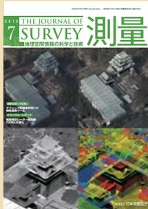
ヘリコプター搭載型航空レーザ計測&マルチカメラシステム「SAKURA」により名古屋城を計測しています。連結式層塔型(大天守五層五階、小天守二層二階)の形状や、大天守の屋根の上に載せられた金鯱(金のしゃちほこ)が見てとれます。また南側に現在本丸御殿の再建工事が実施されています。表紙上段(左・右)、表紙下段(左・右)は、それぞれ写真画像・色付き点群・反射強度・標高段彩を表示します。
