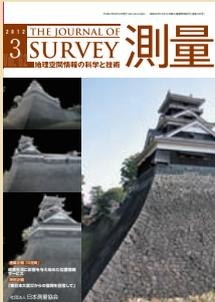
表紙右側は、熊本城内に現存する宇土櫓(やぐら)とそれを支える石垣について、空堀を隔てた箇所から撮影したものです。左側は同様の箇所から地上型レーザスキャナで計測した3次元データから作成した鳥瞰図です。両画像から「扇の勾配」と言われている曲面を持つ高石垣の形態がよく分かります。
